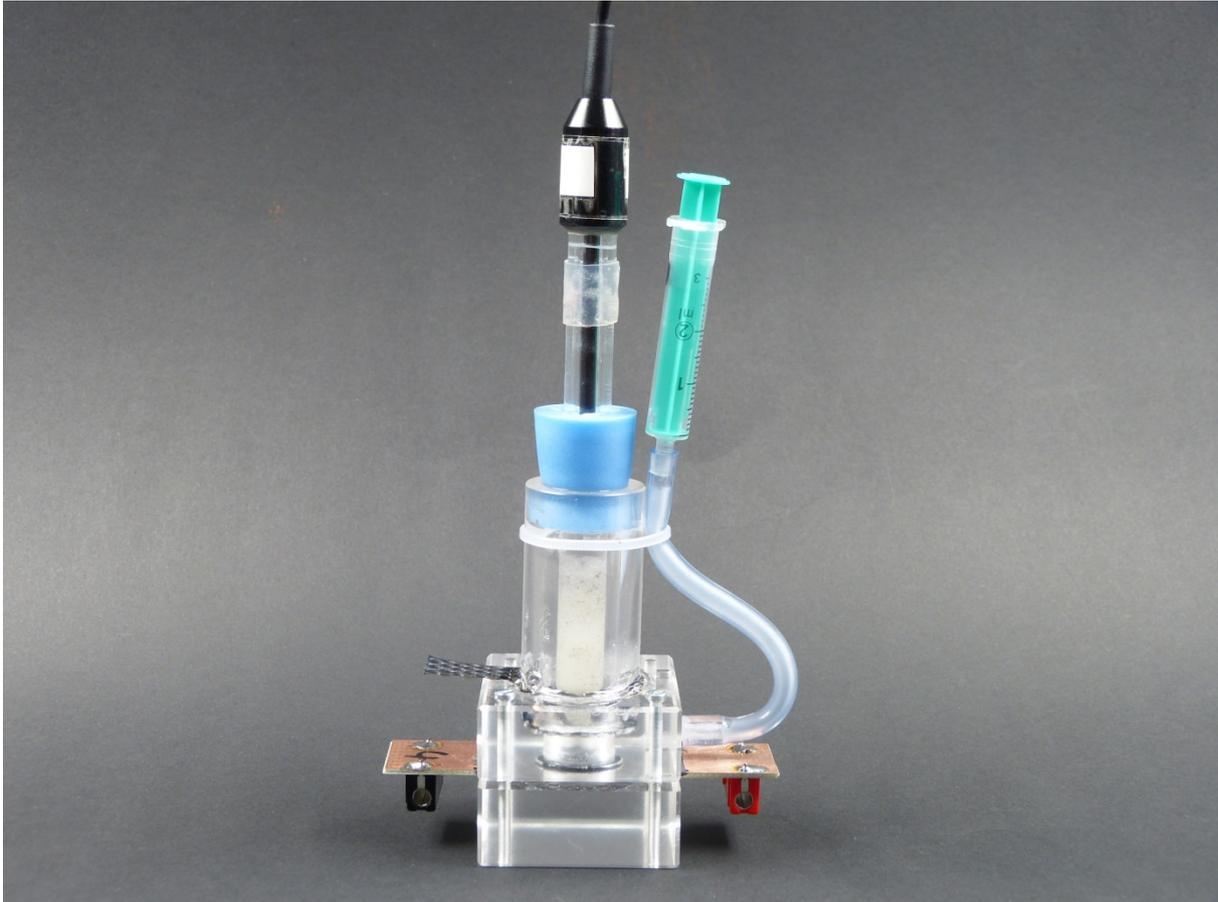
Abb. 17: Elektrochemische Messzelle mit Bypass, Messfläche 3,14 cm<sup>2</sup>
