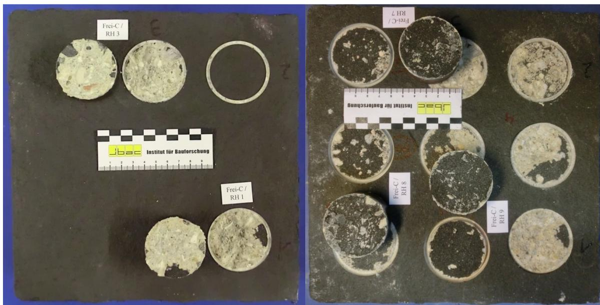
Abb. 75: Bruchbilder eines Prüfkörpers von CBCC3 der Serie FREI mit vorwiegender Überschreitung der Betonzugfestigkeit (links) und späteren Bruchbildern mit vorwiegendem Versagen in der Beschichtung (rechts)
