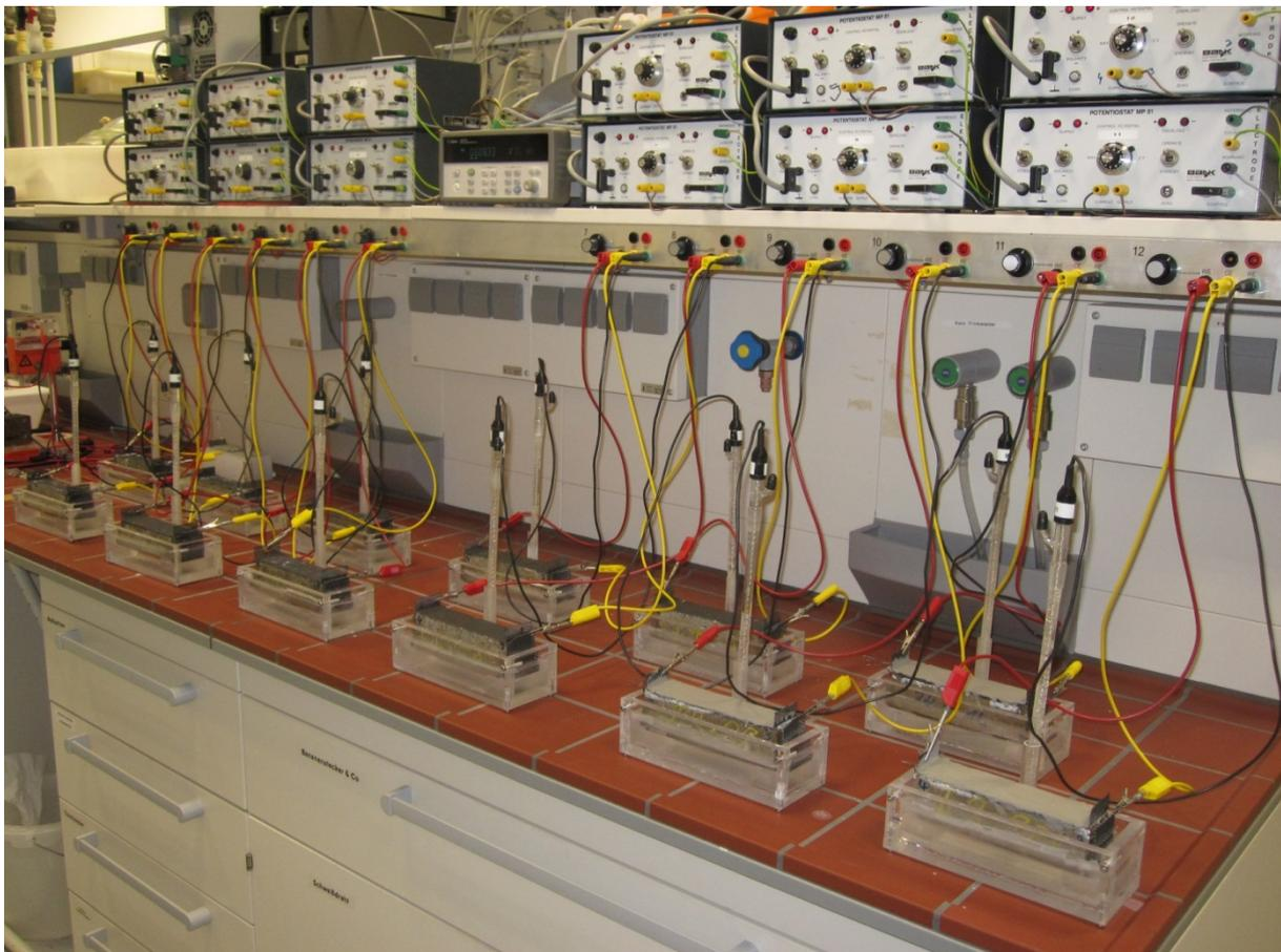
Abb. 77: Galvanostatischer Polarisationsversuch mit 12 Messzellen
