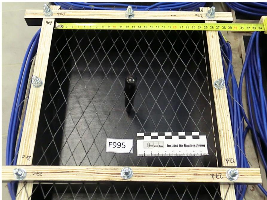
Abb. 59: Schalung vor dem Betoniervorgang
