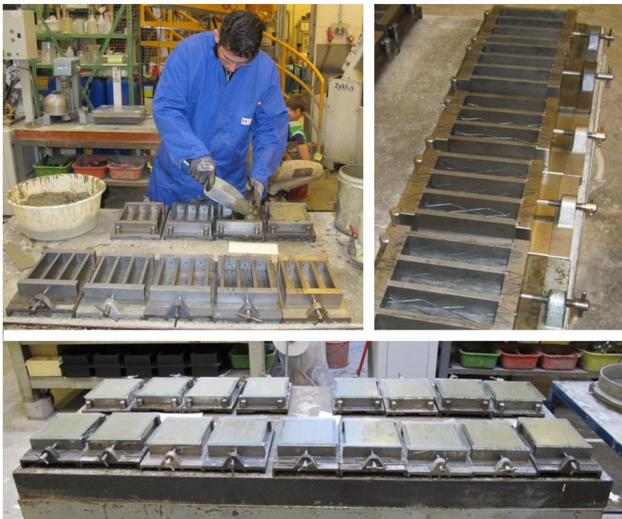
Abb. 14: Probekörperherstellung
