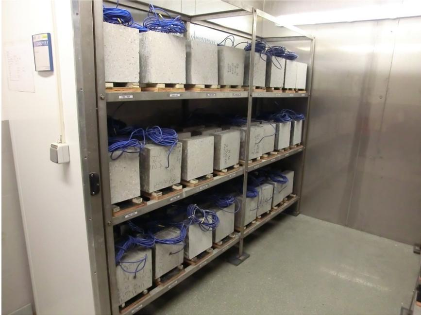
Abb. 62: Prüfkörper in Klimalagerung
