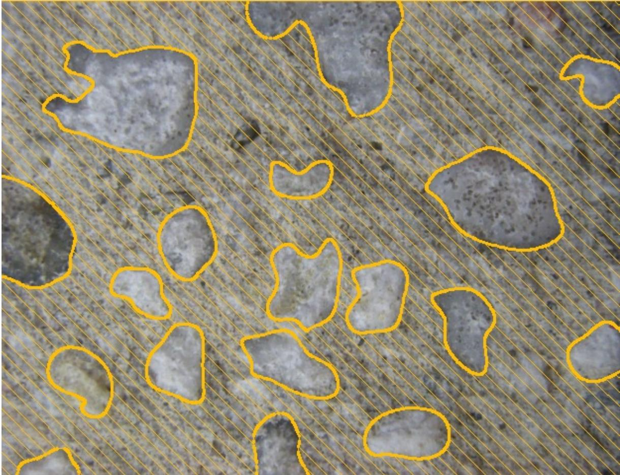
Abb. 52: Schematische Darstellung der elektrolytisch aktiven Betonoberfläche unter der Voraussetzung, dass nicht leitfähige Gesteinskörnungen vorliegen
