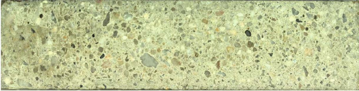
Abb. 15: Geschliffene Unterseite eines Betonprisma
