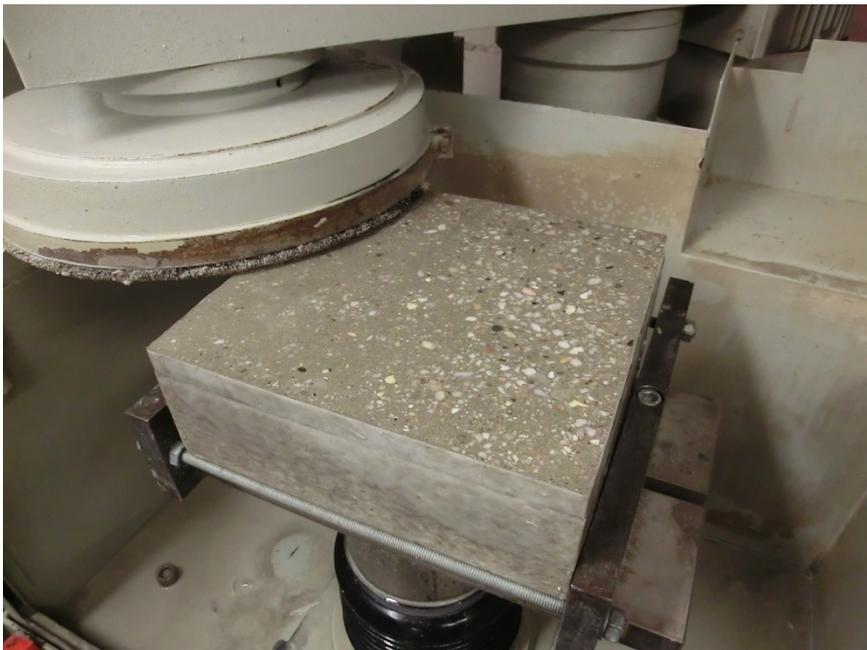
Abb. 61: Schleifen der Prüfkörperoberfläche
