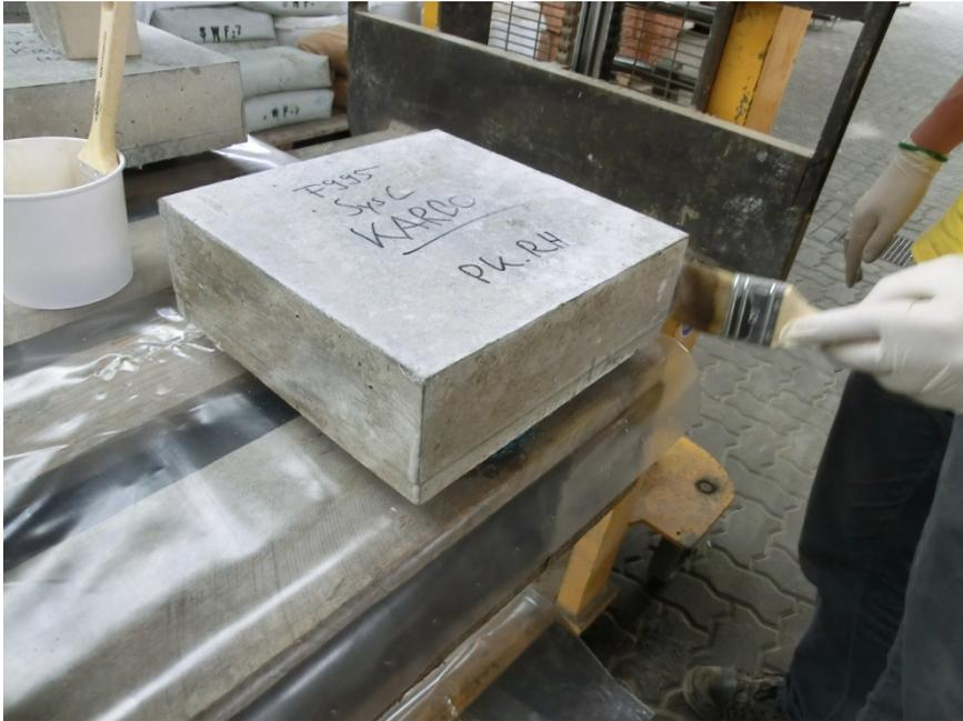
Abb. 60: Beschichten der seitlichen Prüfkörperoberflächen
