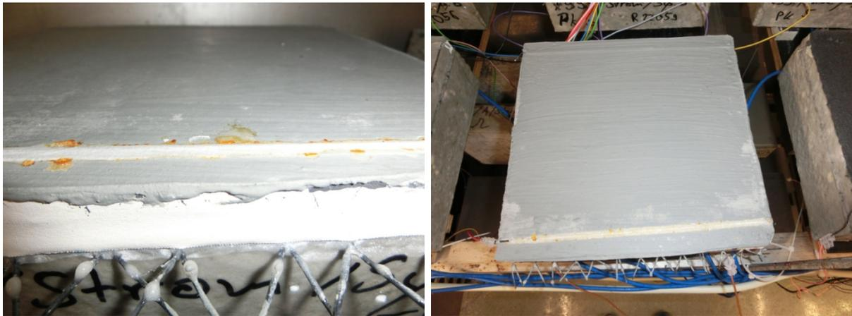
Abb. 68: Visuell erkennbare Veränderungen an den Primäranoden von CBCC1
